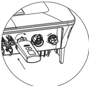
2. Für WLAN-Gerät: Verbinden Sie das WLAN-Gerät mit dem lokalen Router und schließen Sie die WLAN-Konfiguration ab (weitere Einzelheiten finden Sie im mitgelieferten Installationsblatt).
