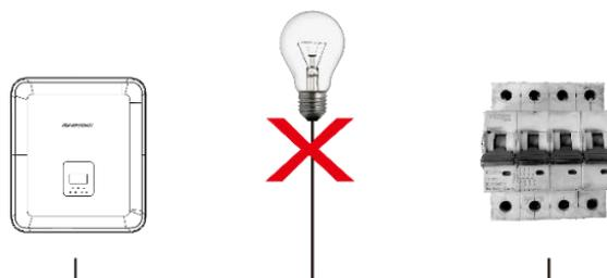
**Bevor Sie mit der Montage des AC-Steckers beginnen, schalten Sie den Leistungsschalter von allen Phasen ab und sichern Sie ihn gegen Wiedereinschalten!**
